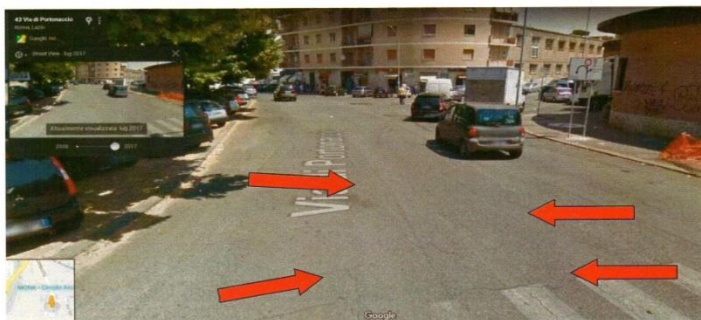
Fotocolore n.16, estratta da Google Maps, nel periodo antecedente il 25 luglio 2017 di Via di Portonaccio (evidenziato dalle frecce rosse il particolare dell'assenza di segnaletica orizzontale di canalizzazione in tre corsie della viabilità, con direzione da Via di Portonaccio direzione Via Tiburtina, nel tratto precedente Via Giuseppe Mirri).
