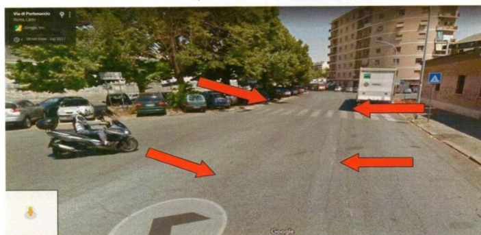
Fotocolore n.17, estratta da Google Maps, nel periodo antecedente il 25 luglio 2017 di Via di Portonaccio (evidenziato dalle frecce rosse il particolare dell'assenza di segnaletica orizzontale di canalizzazione in tre corsie della viabilità, con direzione da Via di Portonaccio direzione Via Tiburtina, nel tratto adiacente Via Domenico De Dominicis).
